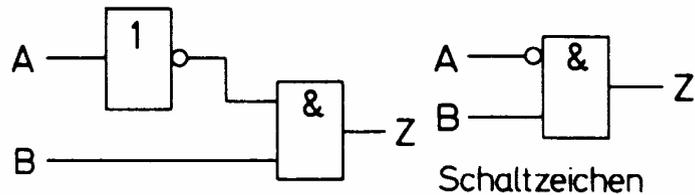
Bild 2.26 Entstehung der Verknüpfung «Inhibition A» und Schaltzeichen
