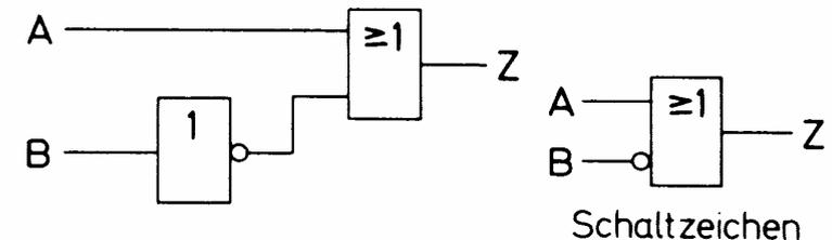
Bild 2.29 Entstehung der Verknüpfung «Implikation B» und Schaltzeichen
