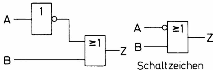
Bild 2.28 Entstehung der Verknüpfung «Implikation A» und Schaltzeichen
