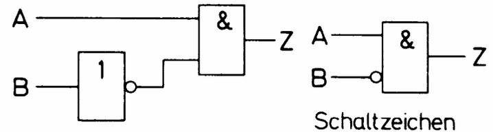
Bild 2.27 Entstehung der Verknüpfung «Inhibition B» und Schaltzeichen
