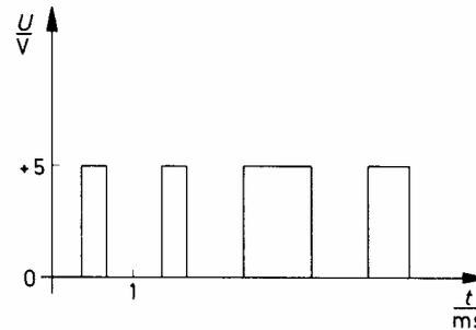
Bild 1.6 Zeitlicher Verlauf eines digitalen Signals
